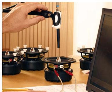
Tradition: Die Weiche wird per Simulation wie per Gehör optimiert (links). Die Chassis-Serienkonstanz dagegen lässt sich nur mit Mikro überprüfen.
