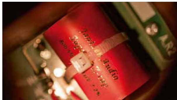
Zwrotnicę schowano w podstawie. Kondensator Jantzena w torze tweetera to jedyny element filtrujący. Drugą połowę bardzo minimalistycznej zwrotnicy stanowi cewka powietrzna. Bez dopracowania konstrukcji głośników takie uproszczenie filtrów dałoby nie najlepsze efekty...
