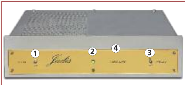
Vue de face de l'alimentation du processeur 1 - Interrupteur de mise sous tension des circuits d'alimentation des étages numériques. 2 - Voyant indicateur de mise sous tension. 3 - Interrupteur de mise sous tension des circuits analogiques. 4 - Façade acier poli, plaque signalétique dorée.
