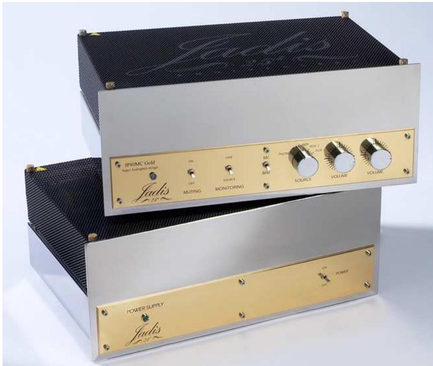
↑簡潔的機箱是為了不感磁而使用不鏽鋼材料，加上前方的鍍金銅板，就成了讓人津津樂道、一見鍾情的雋永產品外觀。在二十五年前，Jadis 就知道干擾是前級純淨訊號的大敵，因此將電源部份分離，二十五年來都不必大幅修改此一線路，可見設計者的高瞻遠矚。新一代的機種兩個音量旋鈕用的是級進式音量衰減器，而且還很費工的左右分離。左右分離音量調整不是很麻煩嗎？別擔心，Jadis 也想到了這點，兩個音量之間有履帶帶動，只要轉動一邊，另外一邊也會跟著轉。
