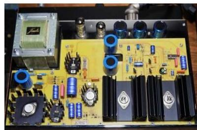
↑JP80MC Gold的電源機箱，可以看到有使用真空管進行電源處理。連電源變壓器都是Jadis自行在廠內繞製的。
