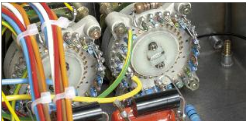
Silberkontaktierte Lautstärke-Stufenschalter mit Einzelwiderständen
