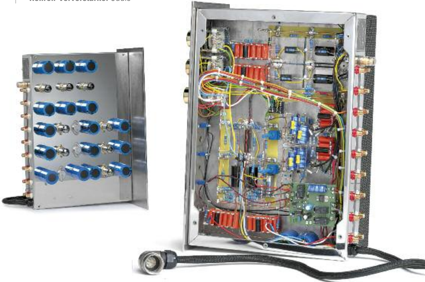
Bis auf eine sind alle Röhren 30 bis 50 Jahre alte „New Old Stock“ von GE und Sovtek. Rechts die aufwendige Freiverdrahtung
