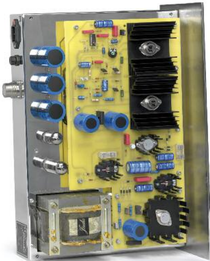
Oben: Endtransistoren allein zur Netzspannungs-Synthetisierung
