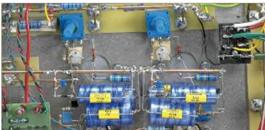
Kanalgetrennter Feinabgleich für die Hochspannung der MC-Stufe
