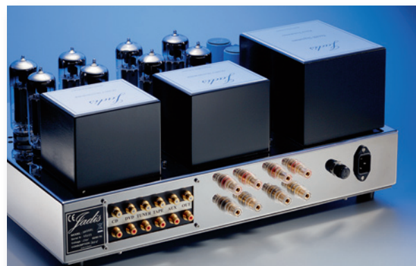
Typowe dla Jadisa gniazda wysokiej jakości, zdwojone zaciski głośnikowe służą wyłącznie do bi-wiringu. Zmiany impedancji wyjściowej dokonuje się wewnątrz obudowy przez zmianę połączenia odpowiednich zworek
