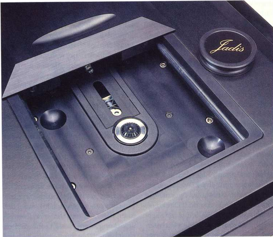
Achtung, Verschlusssache: Wie bei allen Top-Ladern sollte die massive Alu-Lade zum Schutz des Lasers nicht offenstehen
