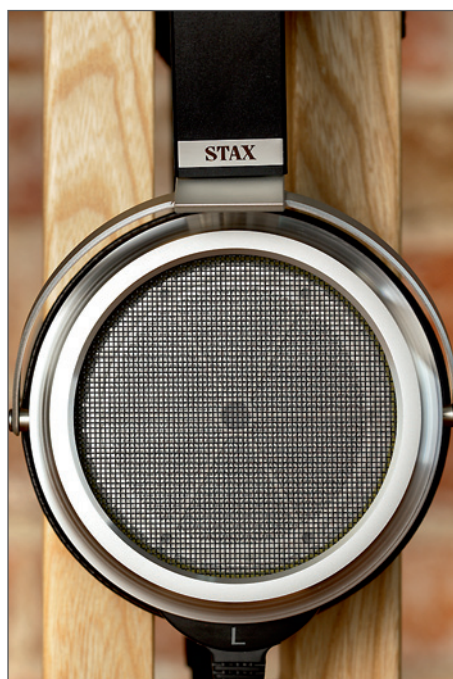
Aluminiowy korpus gwarantuje potrzebną sztywność. Przezroczystość akustyczna muszli jest tak duża jak w poprzednich Staksach. Izolacji od otoczenia praktycznie brak
