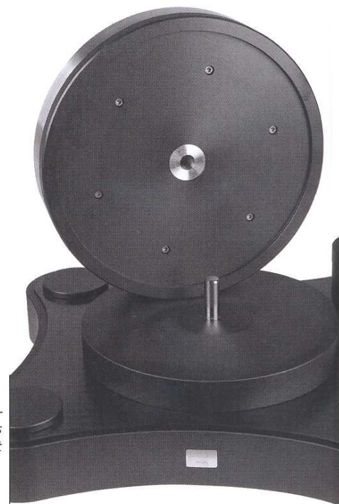
Vier Zentimeter Kupfer und zwei Zentimeter Kunststoff bilden den Teller; das 16-mm-Lager ist von invertierter Bauart
